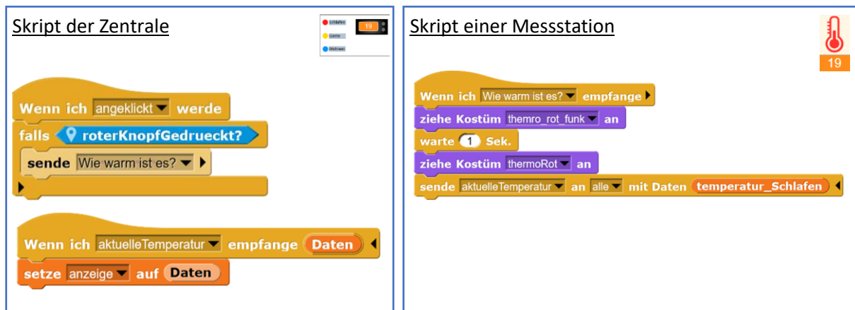
Abbildung 2: Skripte für die zentrale Abfrage-Komponente (links) und eine Messstation (rechts)
